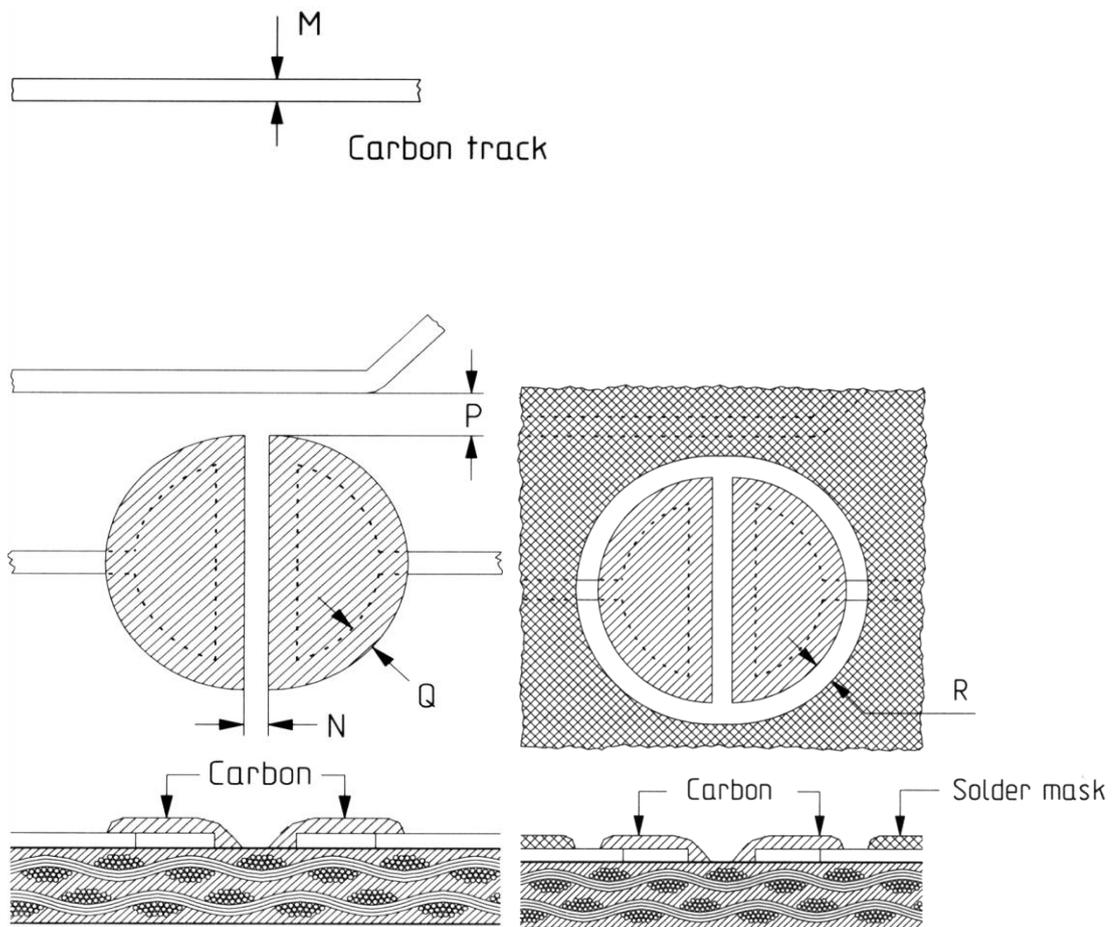
*Fig. 32: Diseño de Pistas de Carbón*
