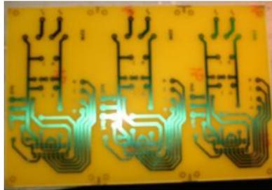
*Fig. 19: Tarjeta impresa luego del ataque con ácido*
