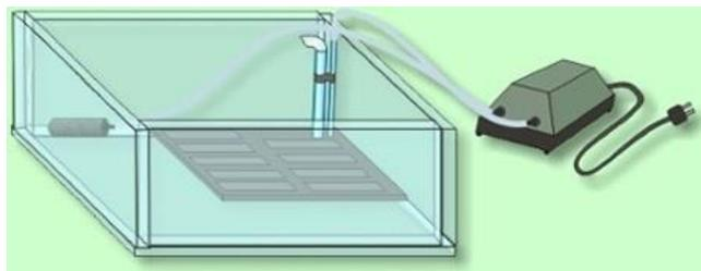
*Fig. 18: Método para acelerar ataque del ácido*
