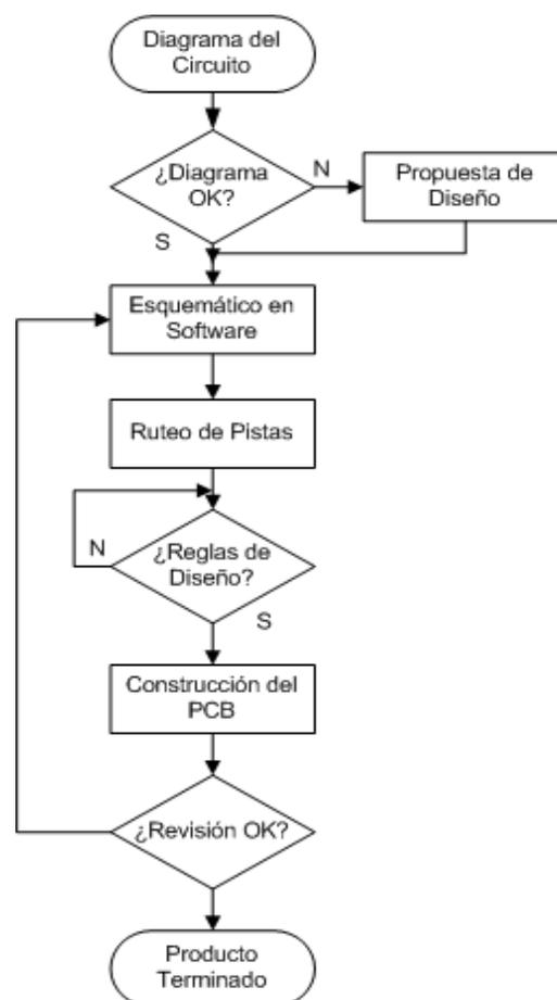
Fig. 2: Flujo para diseño y construcción de PCB's
