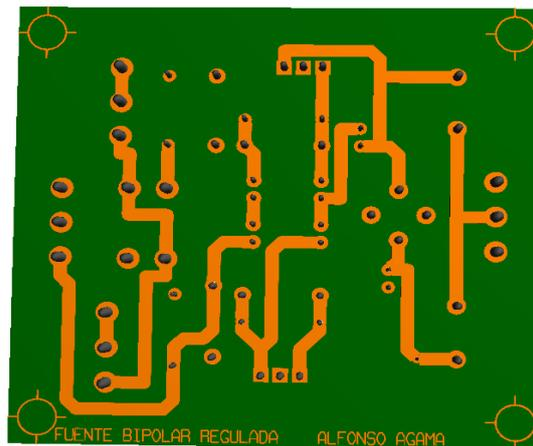
Fig. 9: Vista en 3D lado inferior de la tarjeta
