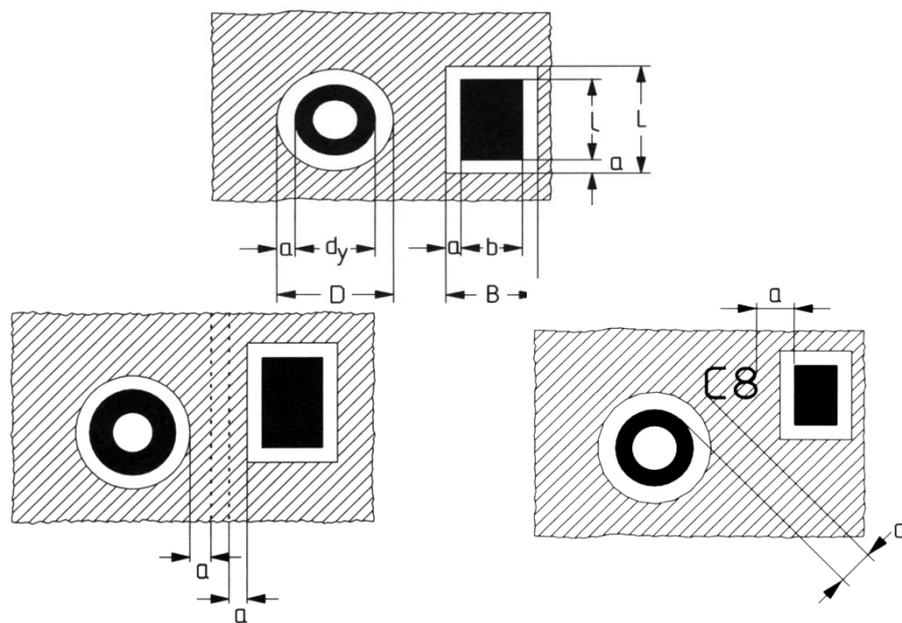
*Fig. 30: Tolerancias en la Máscara de Soldadura*
