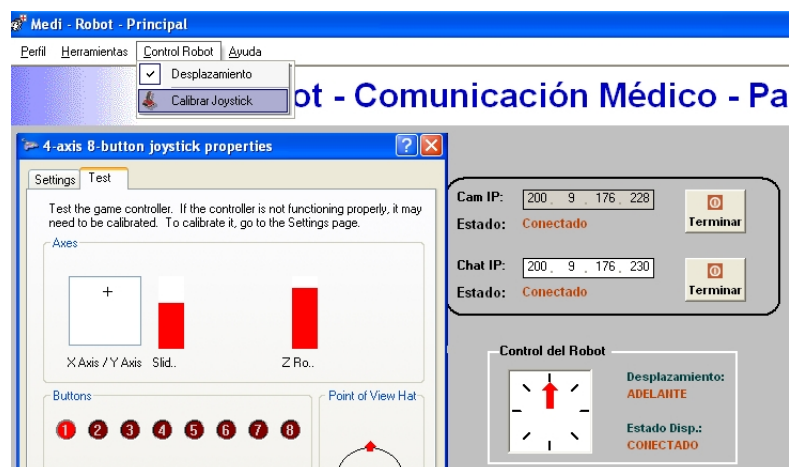
Fig. 3.4: Estación del médico y programa de calibración del joystick
