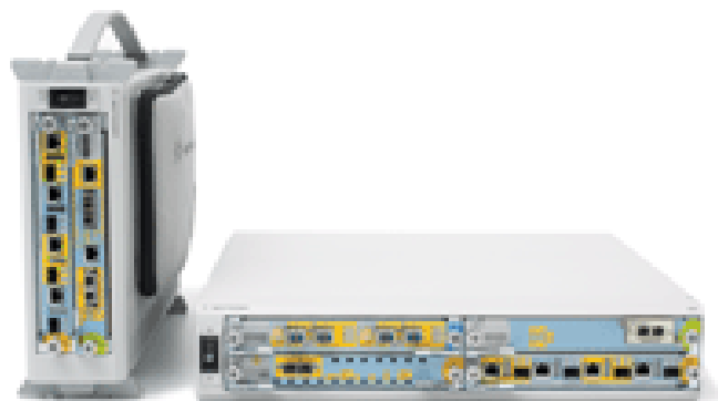
Fig 5.1: Módulos que componen el Chassis del Router Tester 900
