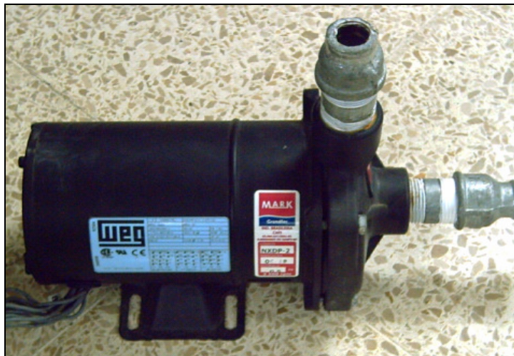
FIGURA A.11. BOMBA CENTRÍFUGA WEG-GRUNDFOS.
