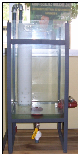
FIGURA 2.11 TANQUE PARA EL CONTROL DE NIVEL.
