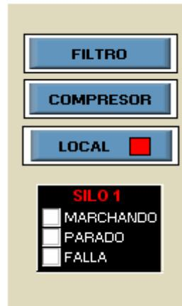
**Fig.4.17 Menú de arranque de extracción.**
