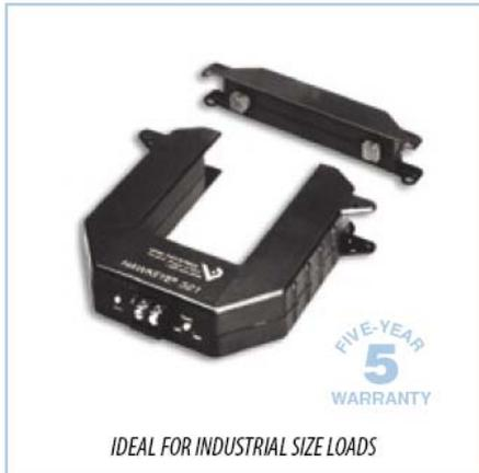
El HAWKEYE 221 es un transductor analógico de corriente el cual provee información de equipos tales como motores que alcanzan corrientes por encima de 2400 Amperios transformándola a un rango de 4 a 20 mA. Cada sensor puede ser calibrado para un máxima resolución usando el potenciómetro de span.
