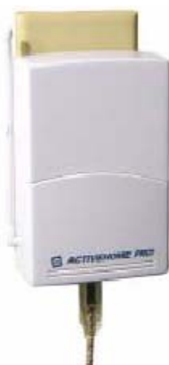
Figura 3.5. Conexión de la Interface CM15A al Tomacorriente.
