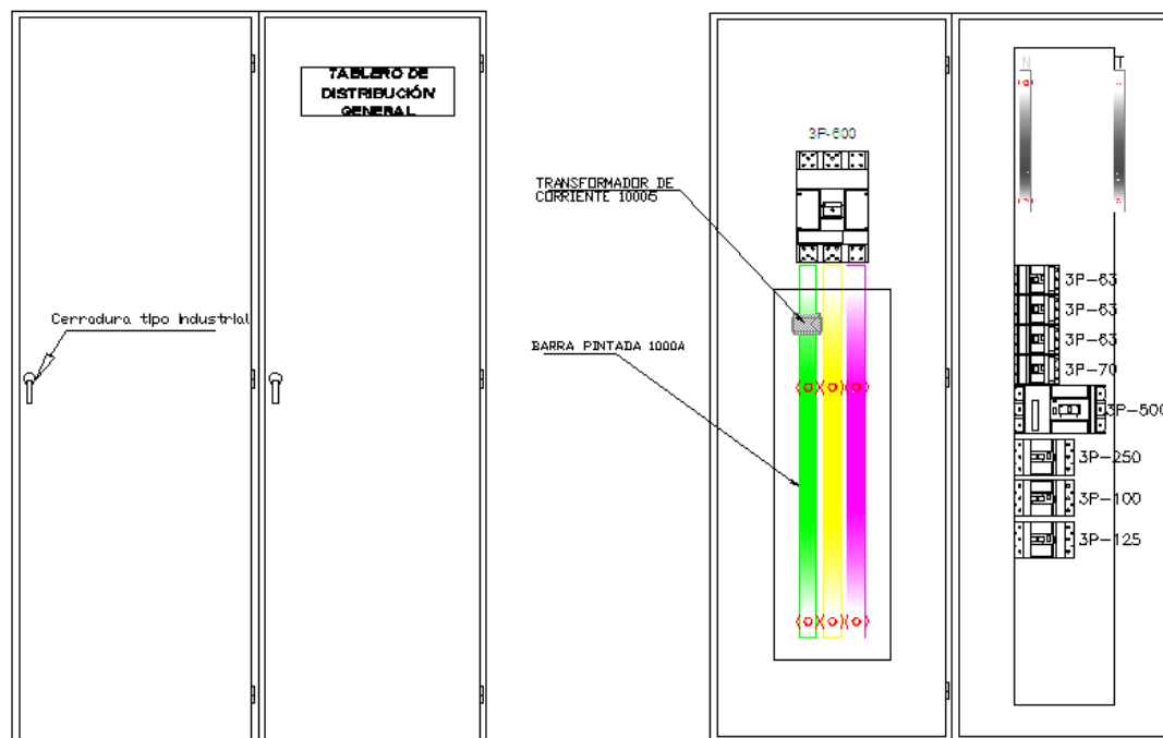
Figura 11.- Vista frontal e interior de un tablero de distribución.
