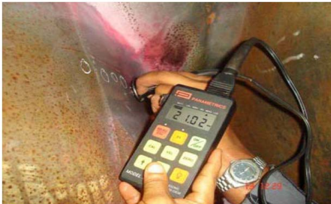
Figura 3.10 Inspección del equipo mediante ultrasonido
