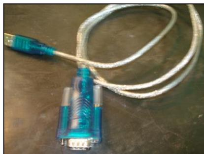
Figura.3.6-Foto real convertidor USB a Serial
