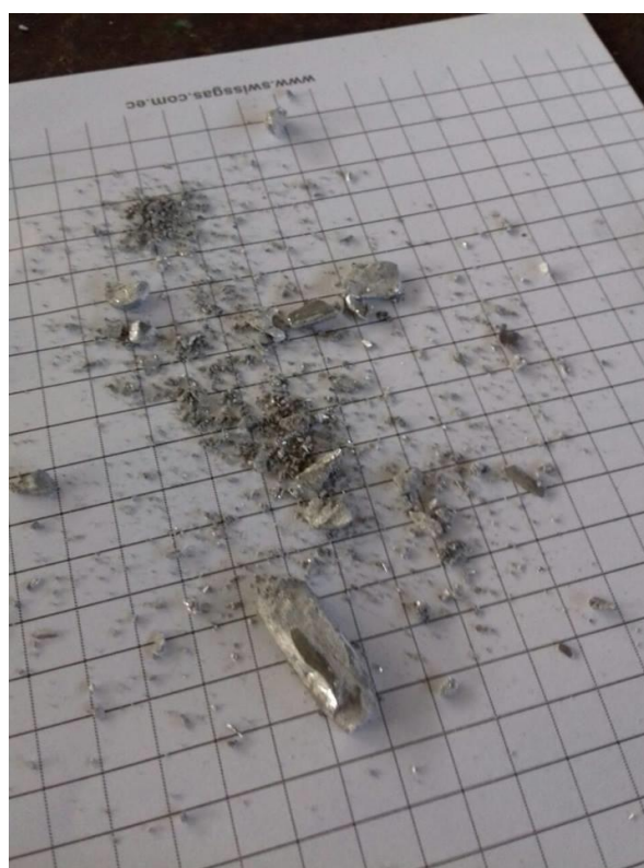
Figura 2.18. Muestra 2 de aluminio, retirada del molde posterior al proceso de prensado y calentamiento.
