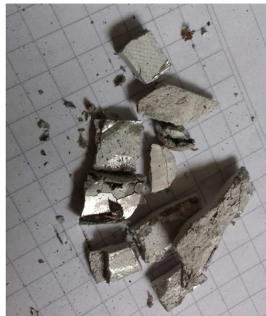
Figura 2.23. Muestra de compuesto de aluminio con oxido de cerio al 2%.
