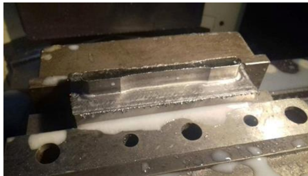
Figura 2.9. Molde macho, finalizado el proceso de mecanizado.
