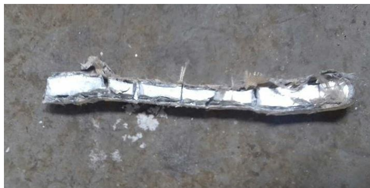
Figura 2.22. Muestra 6 de aluminio, retirada del molde posterior al proceso de prensado y calentamiento.
