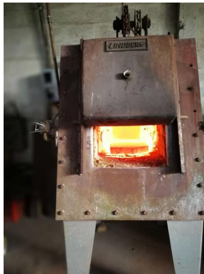
Figura 2.10. Proceso de temple del molde macho en el horno.
