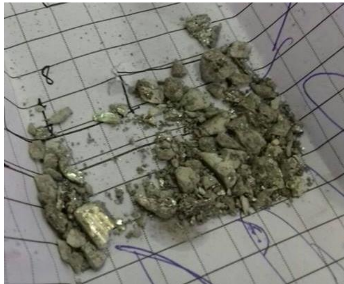
Figura 2.20. Muestra 5 de aluminio en viruta, retirada del molde posterior al proceso de prensado y calentamiento.
