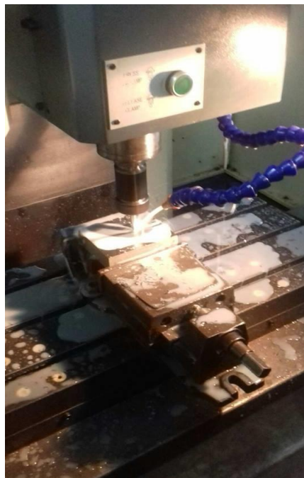
Figura 2.6. Proceso de ranurado al molde hembra, realizado por el centro de mecanizado CNC, utilizando fresa frontal HSS, refrigerado con aceite soluble.
