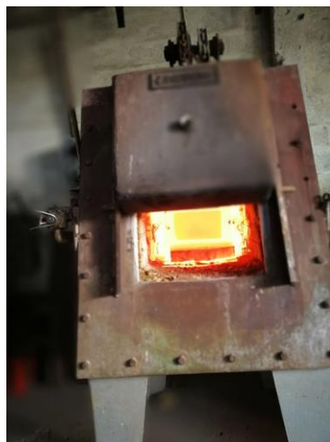
Figura 2.11. Proceso de temple del molde hembra en el horno.
