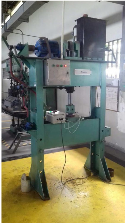
Figura 2.14. Prensa utilizada para la compactación del molde.
