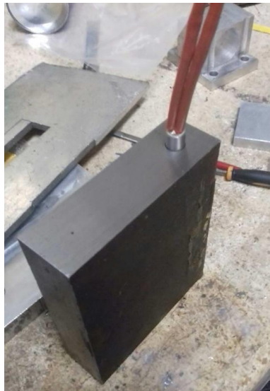
Figura 2.5. Alojamiento de la resistencia eléctrica en el molde hembra, posterior a la operación de taladrado.
