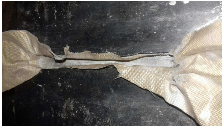
Figura 2.21. Muestra 6 de aluminio con cobertura de teflón, separando la superficie del aluminio y el molde hembra.
