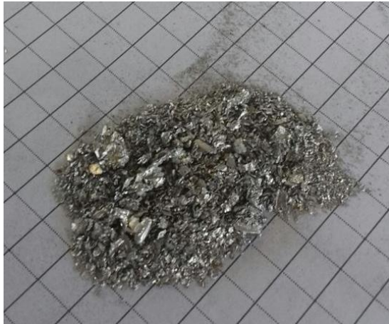
Figura 2.19. Muestra 4 de aluminio en viruta, retirada del molde posterior al proceso de prensado y calentamiento.
