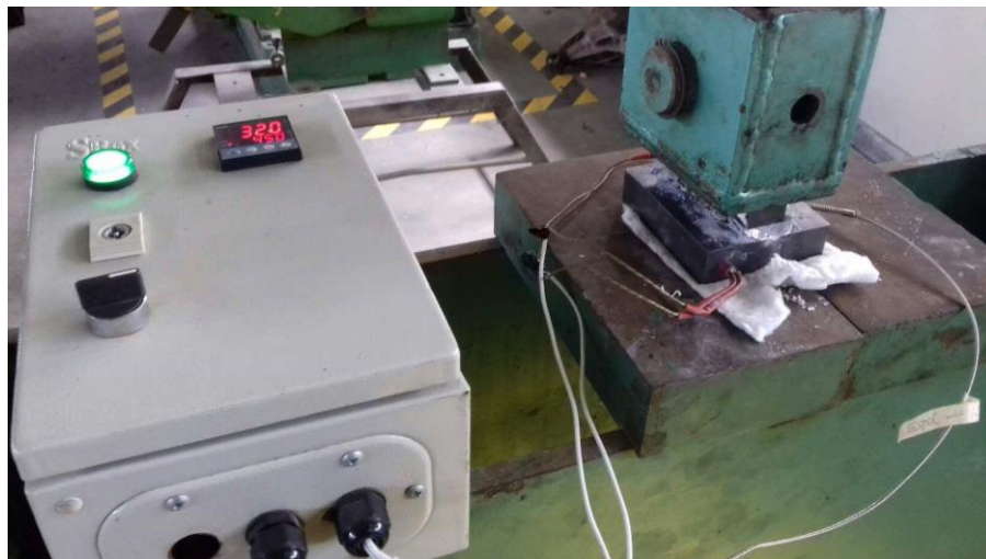
Figura 2.16. Sistema montado en la prensa hidráulica, ejerciendo presión sobre el sistema de moldeo, alcanzando la temperatura de 320 °C.
