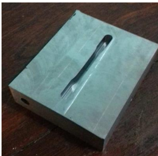
Figura 2.7. Molde hembra, finalizado el proceso de mecanizado.
