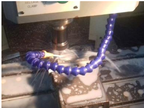
Figura 2.8 Mecanización del molde macho el centro de mecanizado CNC.
