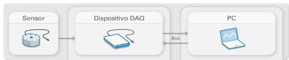
Figura 2.5 Partes de un sistema DAQ
