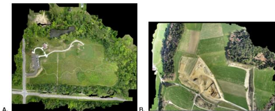
Figura 3.6: A. Resultado de fusión de imágenes usando georreferenciamiento, para el dataset de 77 imágenes. B. Resultado de fusión de imágenes usando georreferenciamiento, para el dataset de 211 imágenes.
