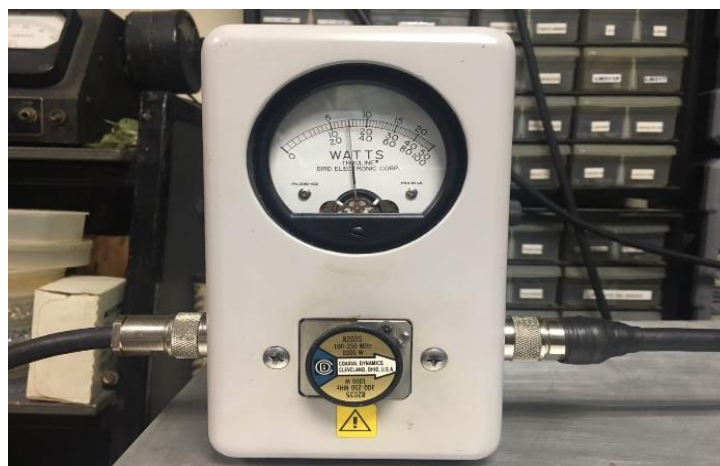
Figura 3.32 Vatímetro marcando una potencia de 300 W
