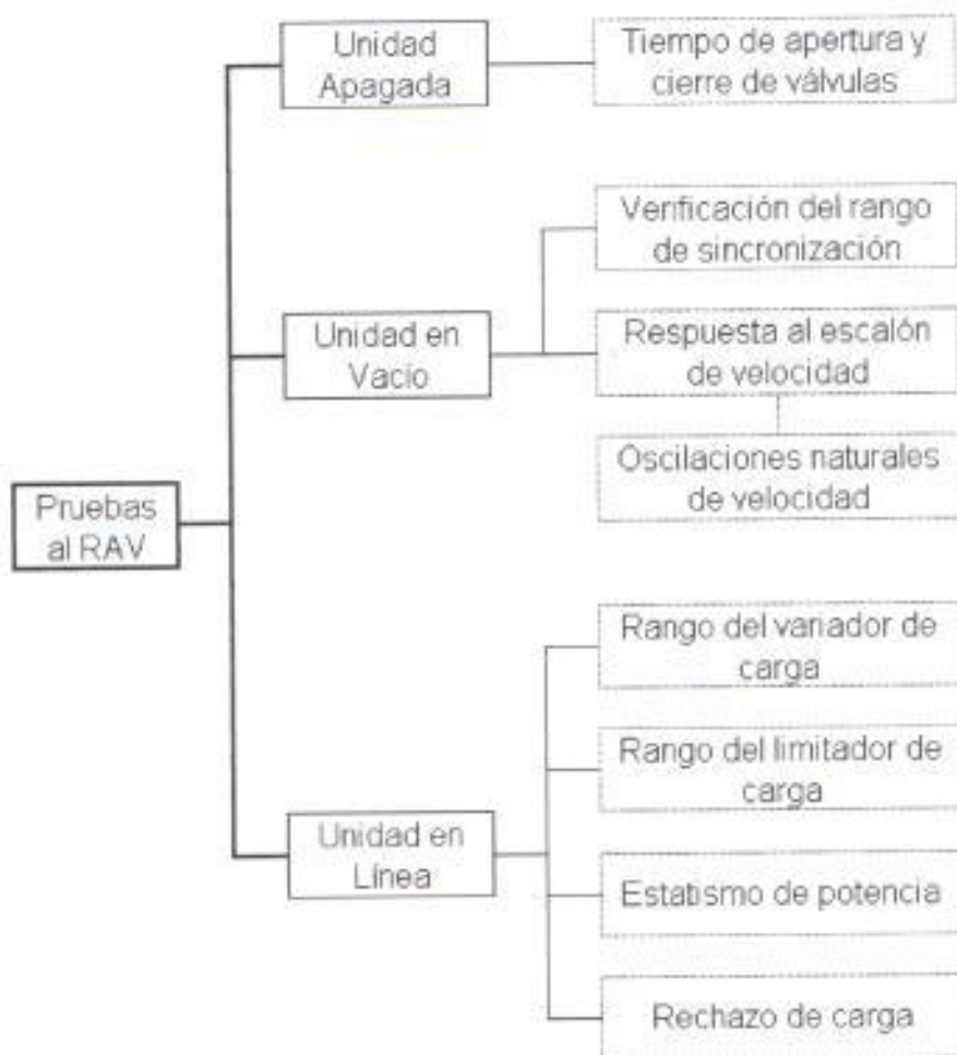
Fig. III: Pruebas al regulador automático de velocidad
