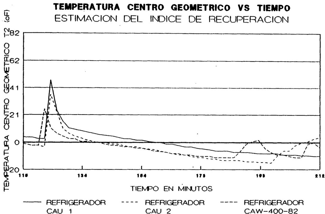
**FIGURA 3.4 COMPORTAMIENTO DE LA TEMPERATURA DEL CENTRO GEOMETRICO EN FUNCION DEL TIEMPO EN EL PERIODO DE RECUPERACION**
