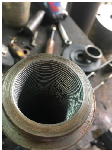
Figura 3.7 Pared interna de camisa modificada
