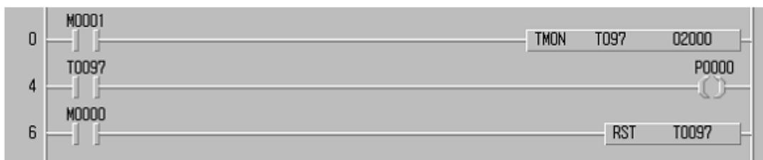
Figura 4.1.4.1 características del temporizador monoestable
