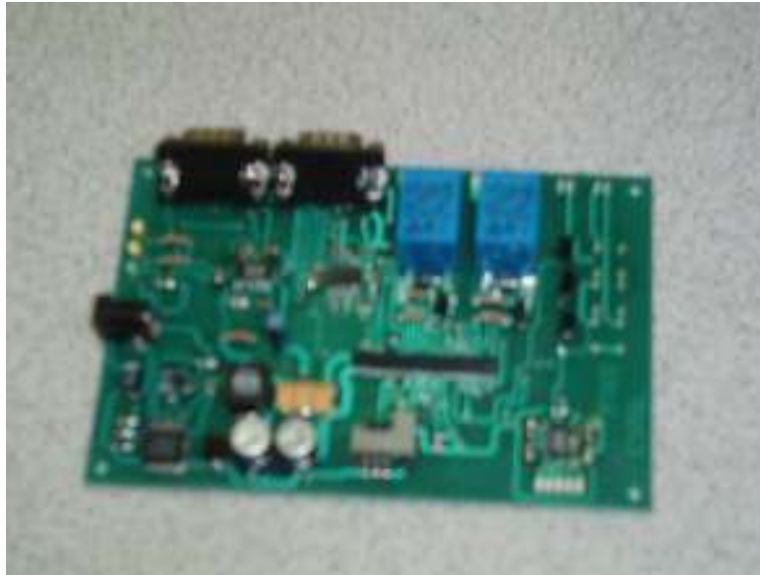
Figura 13. Montaje de Puertos de Comunicación
