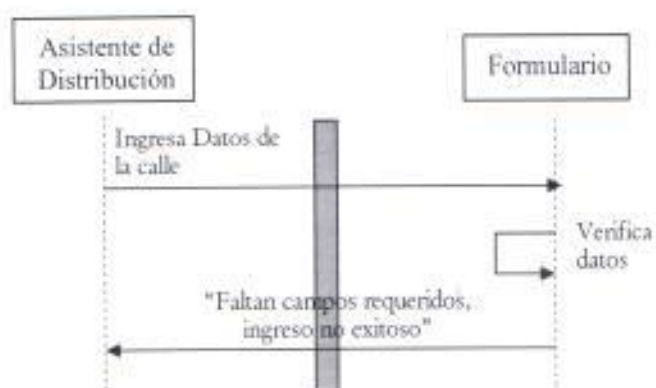
Figura 4.32 Escenario 8.2.- Ingreso no exitoso de los datos de la Calle por no haber ingresado la información exigida
