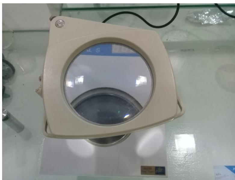
FIGURA 14. MÁQUINA PARA REALIZAR CONTEO DE COLONIA
