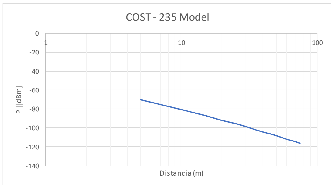
Figura 3.9. Gráfica de Potencia Vs Distancia (Modelo COST235)
