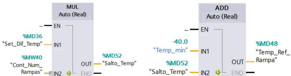
**Figura 15: Programación para la obtención de la variable “Temp\_Ref\_Rampa”.**
