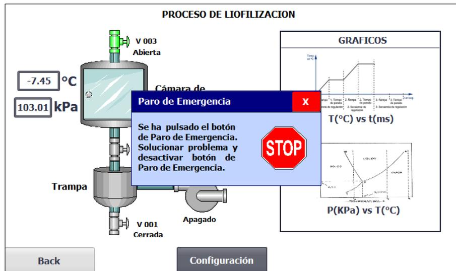
Figura 3.27: Activación del mensaje de aviso de Paro de Emergencia.
