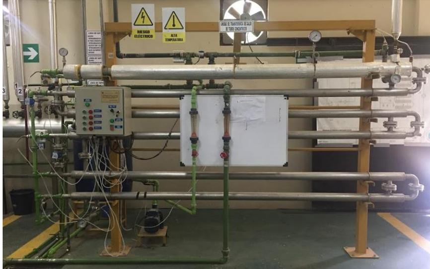
**Figura 3.7. Intercambiador de calor de tubos concéntricos.**
