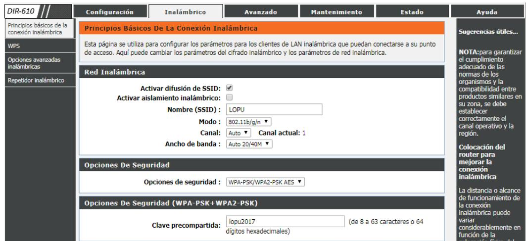
**Figura 2.83. Configuración del nombre y seguridad de la red inalámbrica.**
