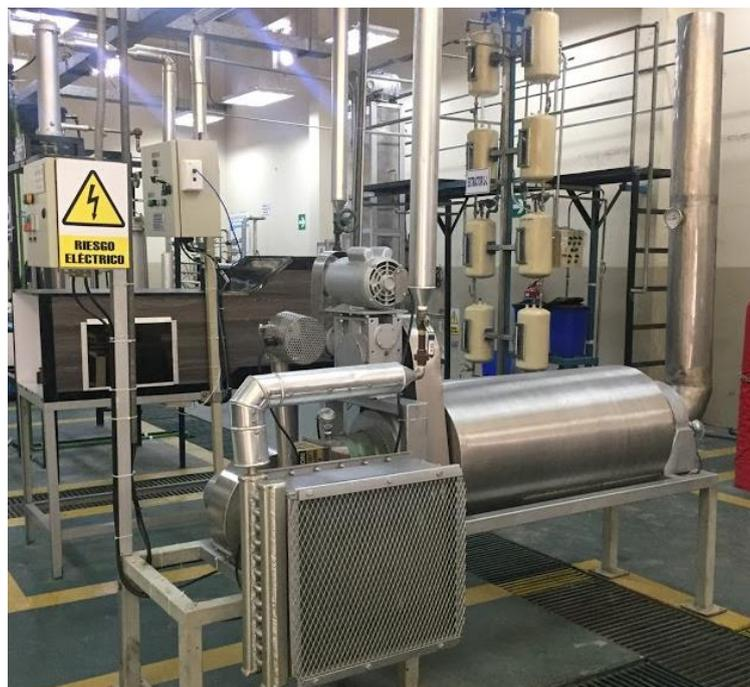
Figura 3.16. Secador rotatorio.
