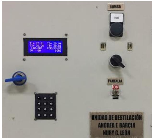
Figura 3.19. Tablero con LCD de la unidad de destilación.
