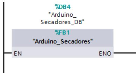
**Figura 2.53. Función actualizada para la configuración de la comunicación y obtención de datos entre PLC y Arduinos.**
