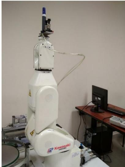
**Figura 4.10 Robot con un marcador en el terminal**
