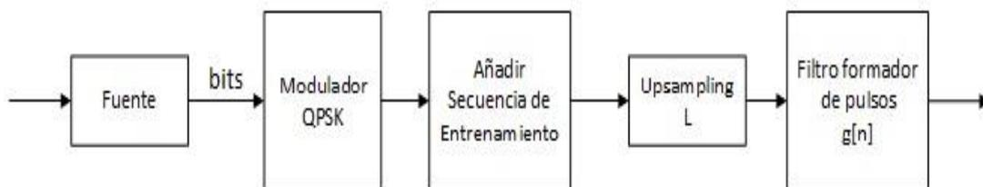
Figura 3.16: Diagrama de bloques del Transmisor de un sistema SIMO.
