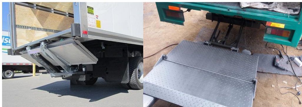
Figura 5 Alternativa 1: Medio mecánico para levantamiento de cargas
