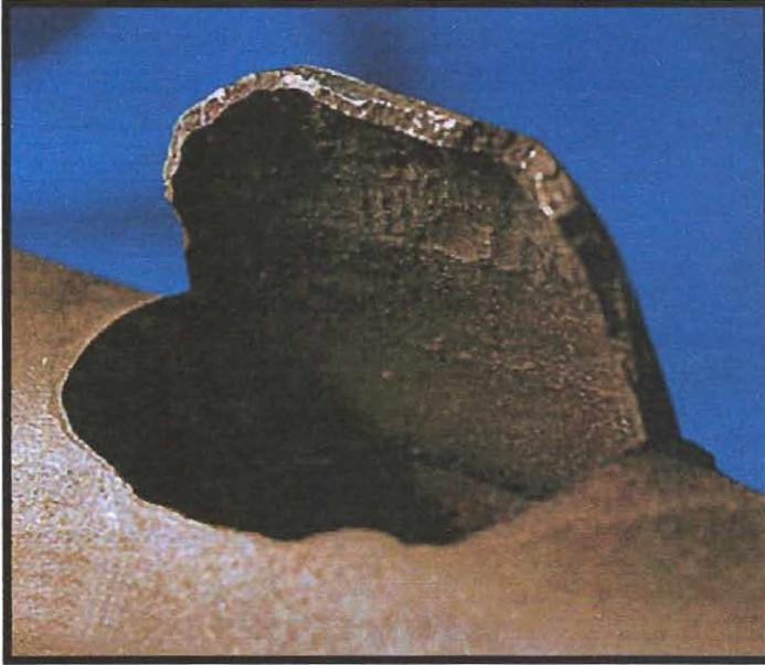
**FIGURA 1.4. ESTALLIDO DE PARED GRUESA RESULTANTE DEL DAÑO POR HIDROGENO. (FUENTE: GUIA NALCO PARA EL ANALISIS DE FALLA EN CALDERAS)**
