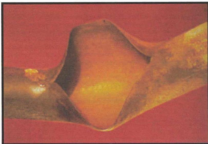
**FIGURA 1.10. SOBRECALENTAMIENTO DE CORTA DURACION EN EL QUE SE TUVO COMBADURA ANTES QUE LA ROTURA. (FUENTE: GUIA NALCO PARA EL ANALISIS DE FALLA EN CALDERAS)**
