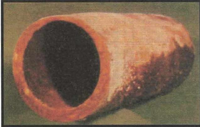
**FIGURA 1.7. ADELGAZAMIENTO DE LA PARED DEBIDO A LA CORROSIÓN POR CENIZA DEL COMBUSTOLEO. (FUENTE: GUIA NALCO PARA EL ANALISIS DE FALLA EN CALDERAS)**
