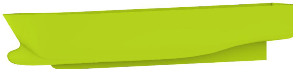
Figura 4.2: Modelo 3D del catamarán con bulbo.
