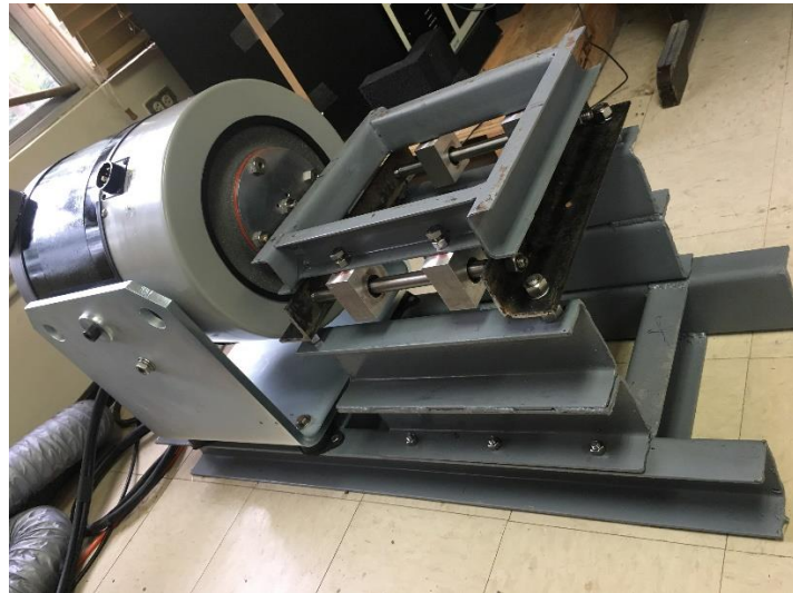
Figura 1.12: Mesa vibratoria construida
