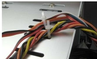
**Figura 1.5 – Exceso de cables en Sistema de alarmas actuales [3]**
