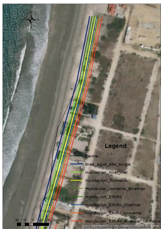
Ilustración 48. Alcance en los diversos escenarios, en condiciones de pleamar en sicigia. Distancia entre Berma y línea de Inundación. Zona 3.
