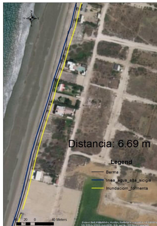
Ilustración 33. Alcance debido a oleaje de tormenta en condiciones de pleamar en sicigia. Distancia entre Berma y línea de Inundación. Zona 2.
