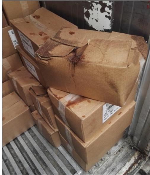
**Figura 2.8 Deterioro de cajas por humedad**
