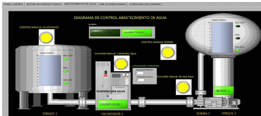
*Figura 4.7 Abastecimiento de agua y sistema de caldero en funcionamiento*
