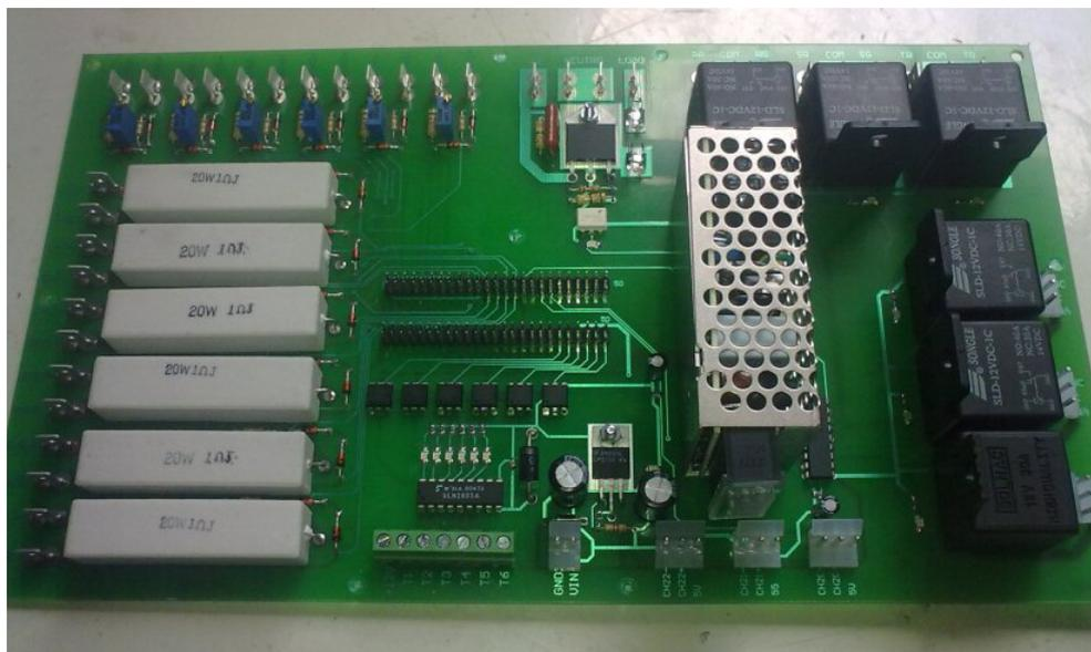
*Figura 3.5. Tarjeta de acondicionamiento de señales*
