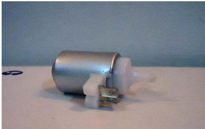
*Figura 3.2. Bomba de limpiaparabrisas de automóvil*
