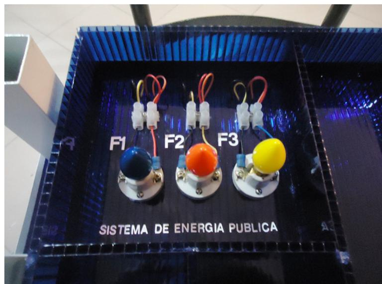
*Figura 3.1 Carga conectada a Energía publica "Trifásica"*
