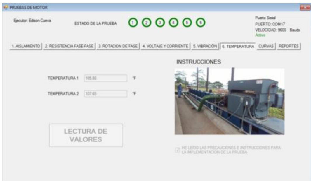
Figura 3. 23 Prueba de temperatura
