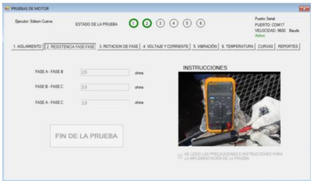
Figura 3. 14 Pantalla de interfaz usuario para pruebas de resistencia
