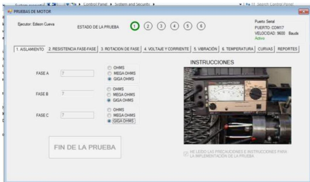
Figura 3. 11 Prueba de aislamiento
