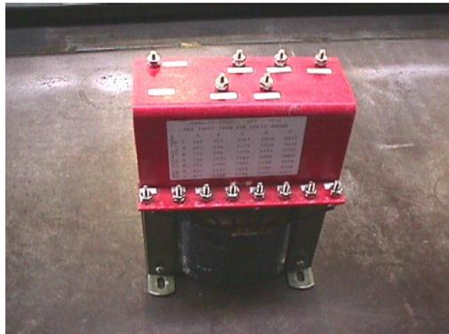
Figura 2. 5 Transformador de control.
