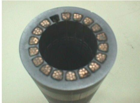
Figura 1. 3 Orificios del estator.
