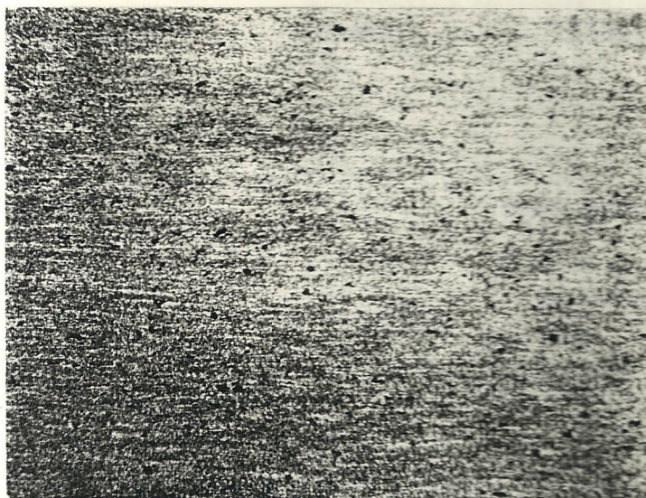
Fig. N° 21: Microestructura del aluminio, la estructura es típica de un proceso de deformación en frío. Las partículas oscuras son compuestos insolubles que contienen principalmente hierro y/o silicio
