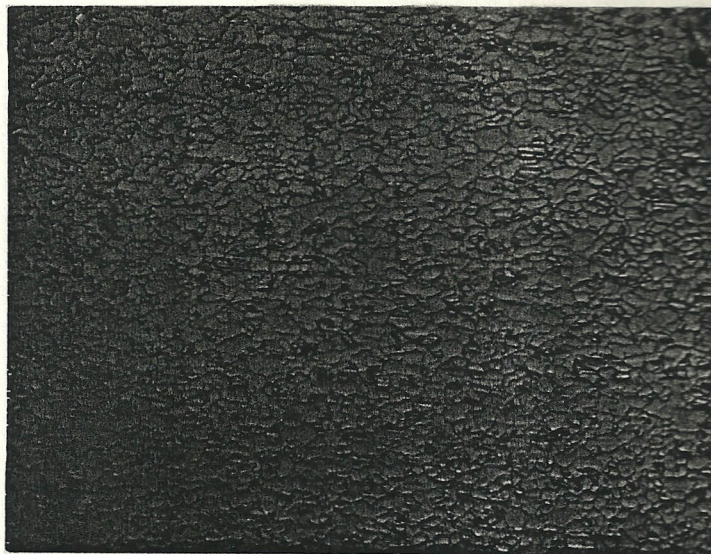
Fig. N° 18: Microestructura del acero de bajo carbono, constituida de granos equiaxiales de ferrita.
