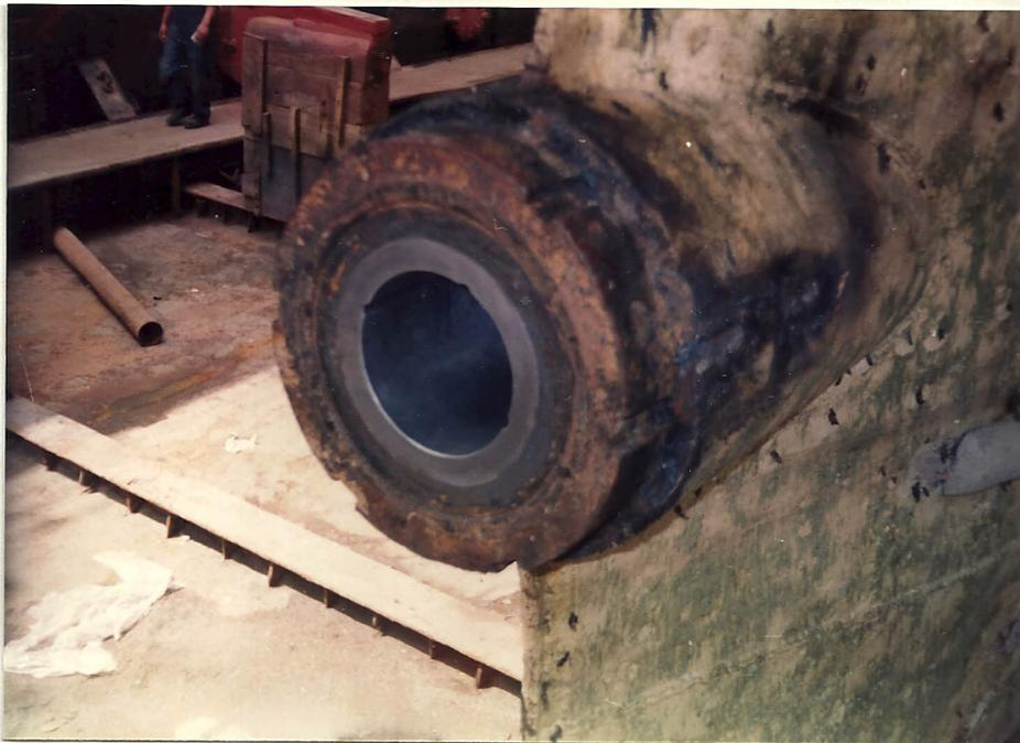
Fig.- 43. Bocín del codaste en posición
