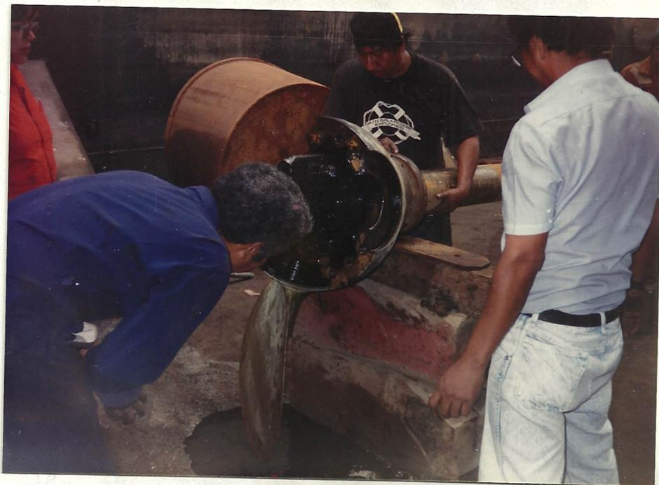
Fig.- 21. Desarmado de la hélice
