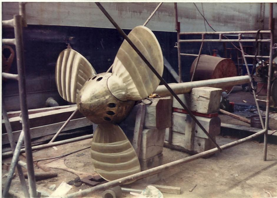
Fig.- 39. Conjunto eje-hélice listo para su montaje
