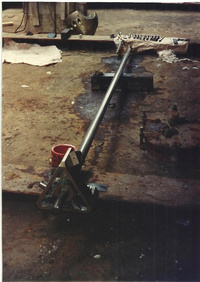
Fig.- 22. Eje control de paso: listo para montaje
