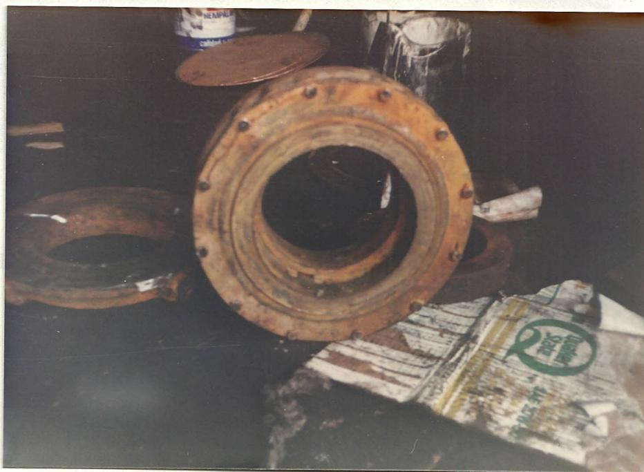
Fig.- 29. Sello interior deteriorado
