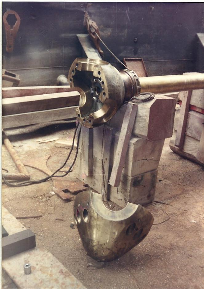
Fig.- 6. Manzana de la hélice desarmada
