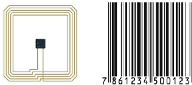
Figura 2. Tecnología RFID vs Código de barras
