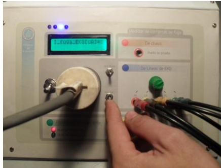
Figura4.14. Switch abrir tierra.
