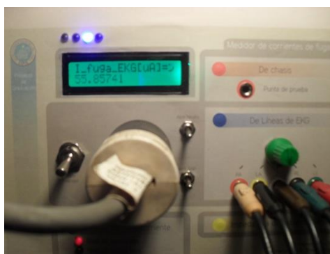
Figura 4.21. Valor de corriente de fuga según la derivación seleccionada.
