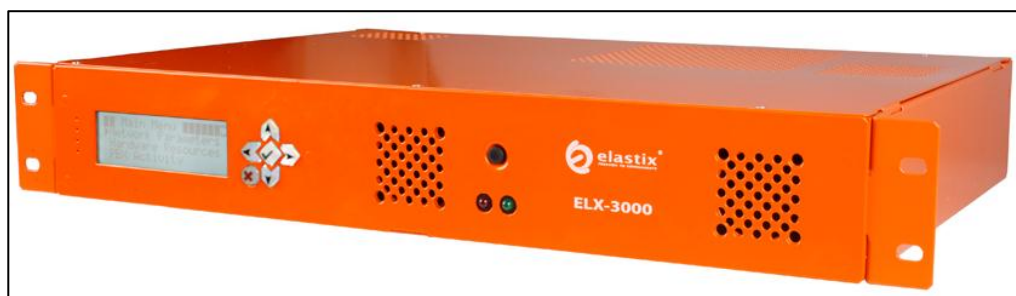
Figura 3.3. Parte delantera del Servidor de Comunicaciones ELX-3000 [32].
