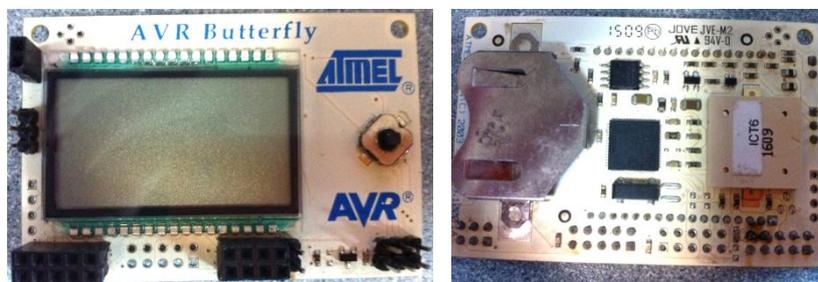
Figura 2.18.: Vista de doble cara de la tarjeta AVR Butterfly, desarrollada por el fabricante ATmega.
