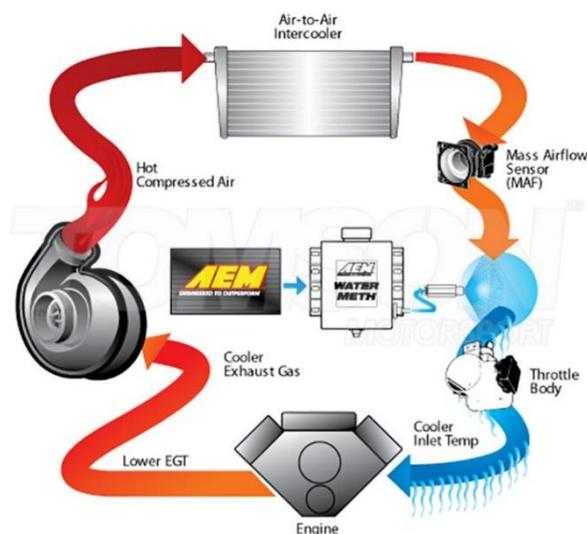
**Figura 1.1 Sistema de inyección de agua de AEM**
