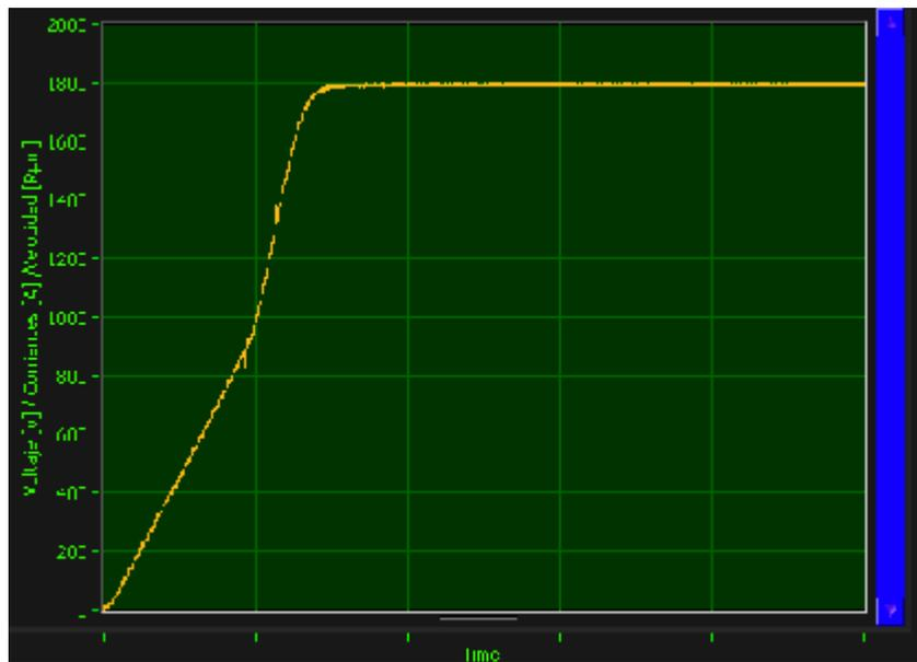
Figura 4.31 Curva de Velocidad en Arranque por Autotransformador 75%Vn (TERCO)
