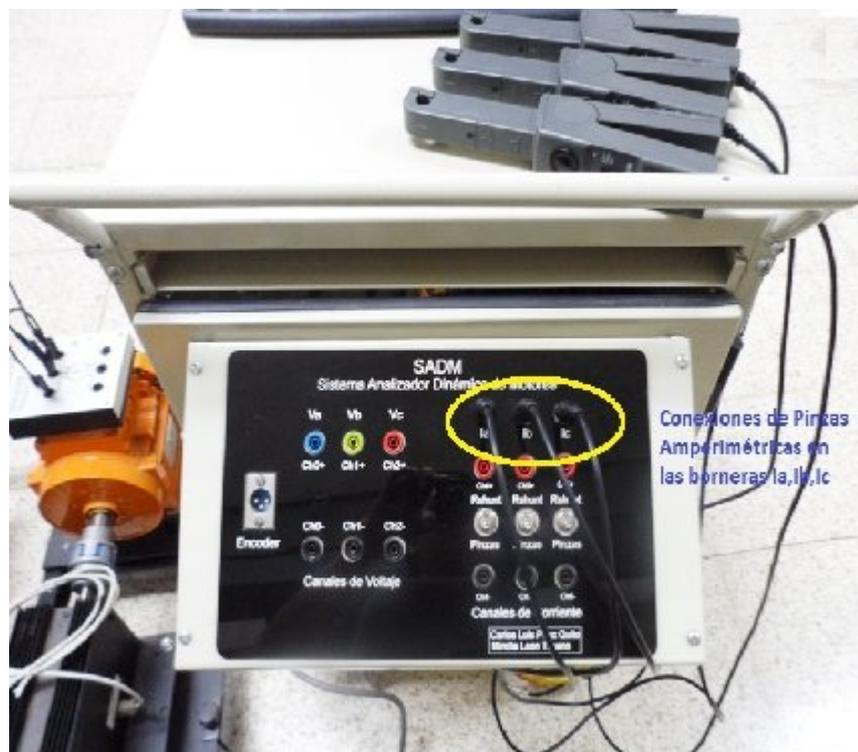
Figura A - 14 Conexión de Pinzas Amperimétricas en el SADM
