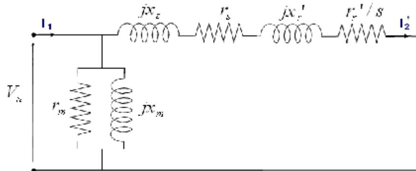
Figura 1.4 Circuito equivalente aproximado referido al rotor.
