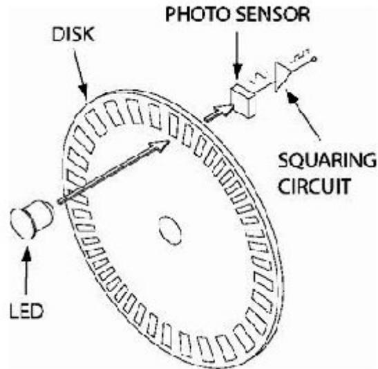
Figura 3.16 Constitución básica de un encoder. [15]
