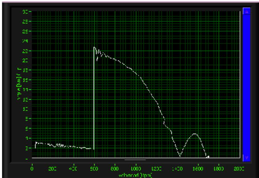
Figura 4.42 Torque en Arranque por Devanados Parciales
