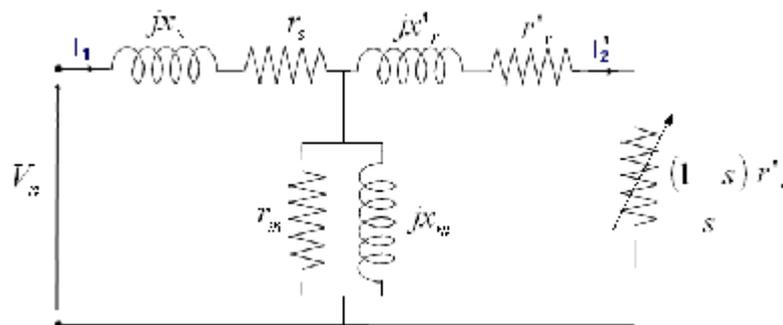
Figura 1.6 Circuito equivalente de un motor de inducción.
