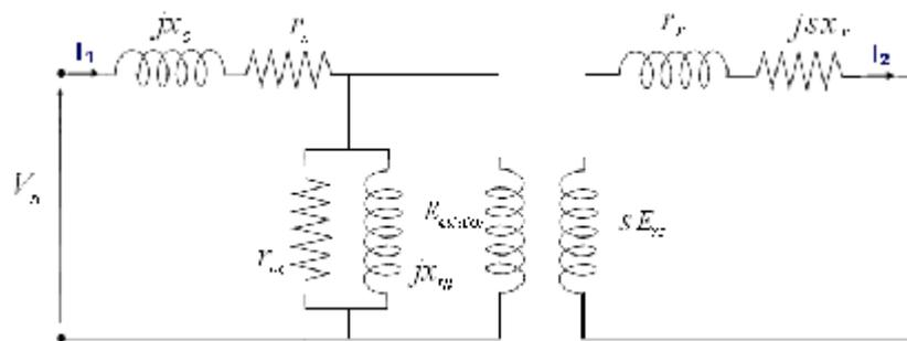
Figura 1.2 Circuito equivalente del estator y rotor.
