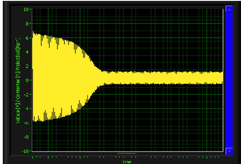
Figura 4.27 Corriente en arranque al 75% del voltaje nominal
