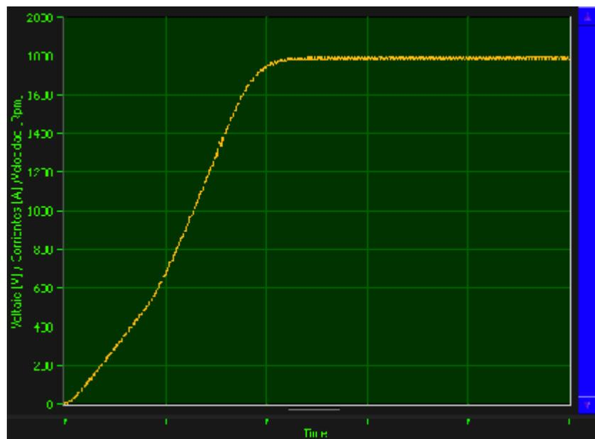
Figura 4.19 Velocidad Mediante Resistencias Estatóricas (TERCO)
