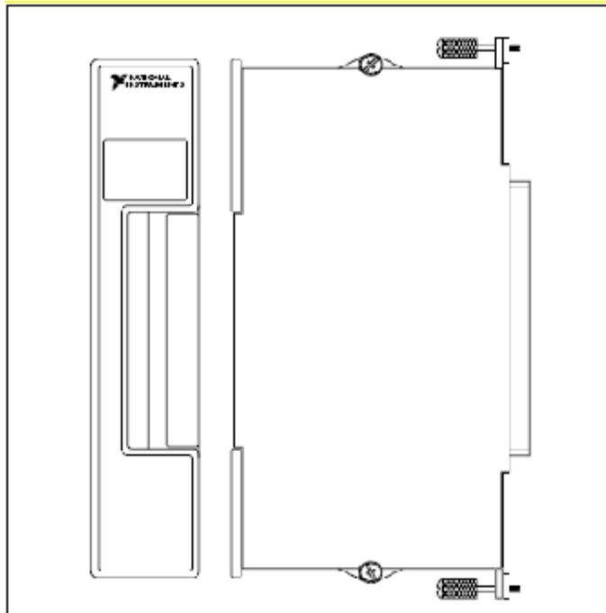
Figura 3.14 Bloque terminal SCXI 1313 vista frontal y lateral. [12]
