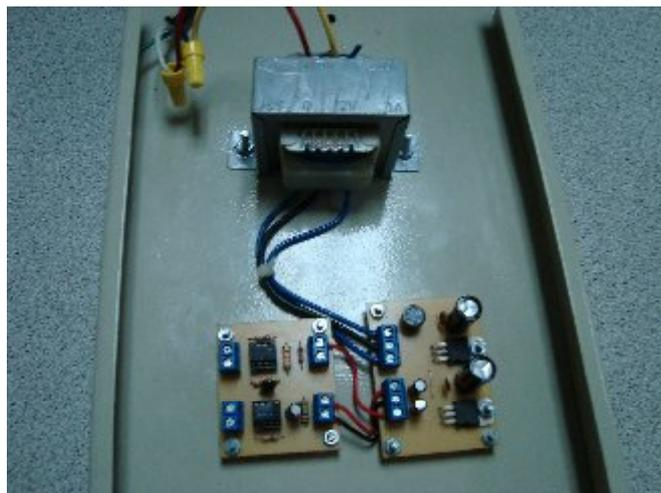
Figura 4.3 Circuito convertidor de frecuencia a voltaje.
