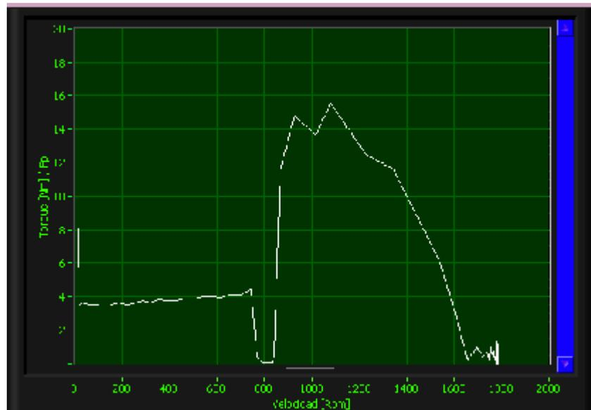
Figura 4.35 Torque en el Arranque Estrella-Delta (TERCO)
