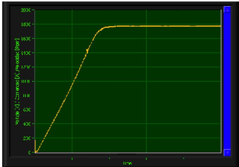
Figura 4.28 Velocidad en arranque al 75% del voltaje nominal
