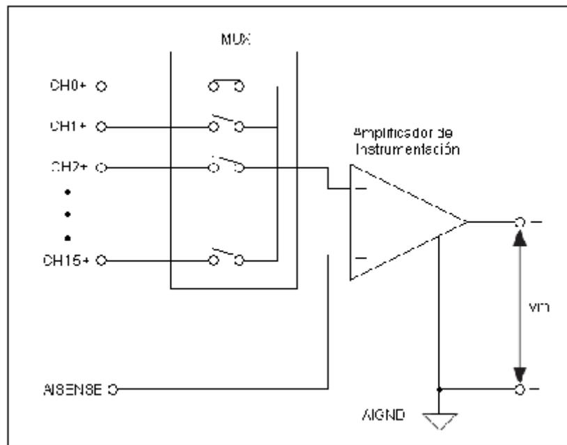
Figura 3.7 Sistema típico de Medición No Referenciado (NRSE) [7]
