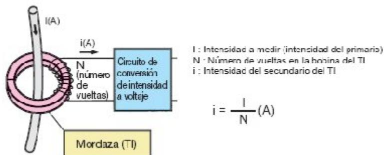
Figura A - 1 Principio de pinza amperimetrica AC
