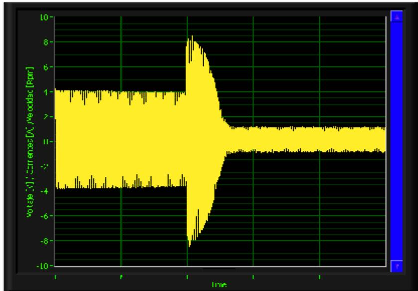
Figura 4.24 Corriente en Arranque por Autotransformador 50%Vn (TERCO)
