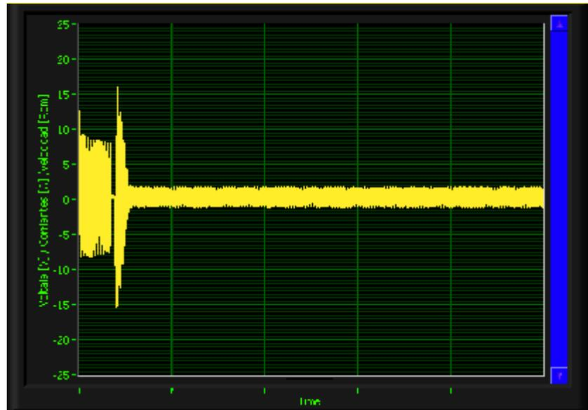
Figura 4.36 Corriente en el Arranque Estrella-Delta (TERCO)
