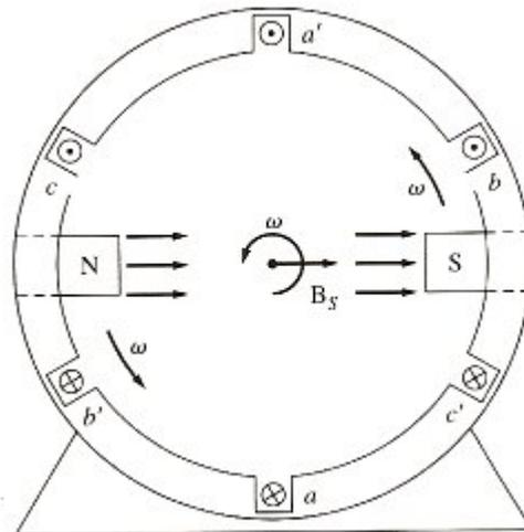
Figura 1.1 Campo magnético giratorio en un estator representado por dos polos norte y sur. [3]
