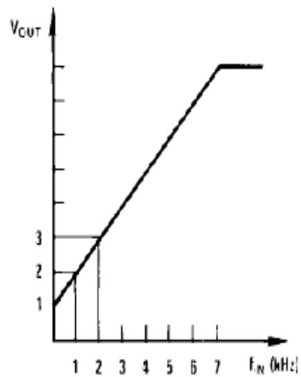
Figura 3.19 Respuesta del circuito convertidor de frecuencia a voltios.[16]
