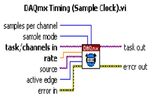
Figura 2.20 Función DAQmx Timing.
