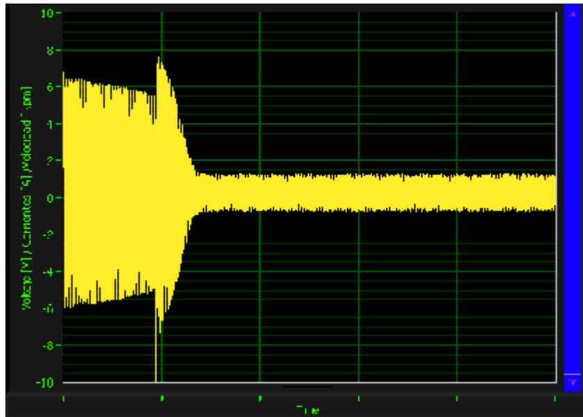
Figura 4.30 Corriente en Arranque por Autotransformador 75%Vn(TERCO)
