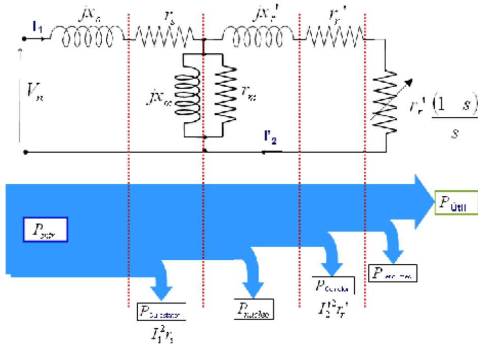
Figura 1.5 Diagrama de potencias en un motor de inducción.[1]
