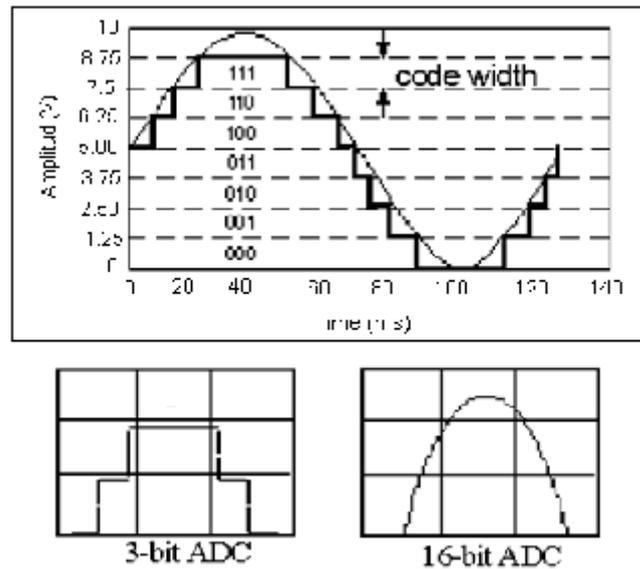
Figura 3.8 Ejemplo de Resolución de 3 Bits y 16 Bits. [7]
