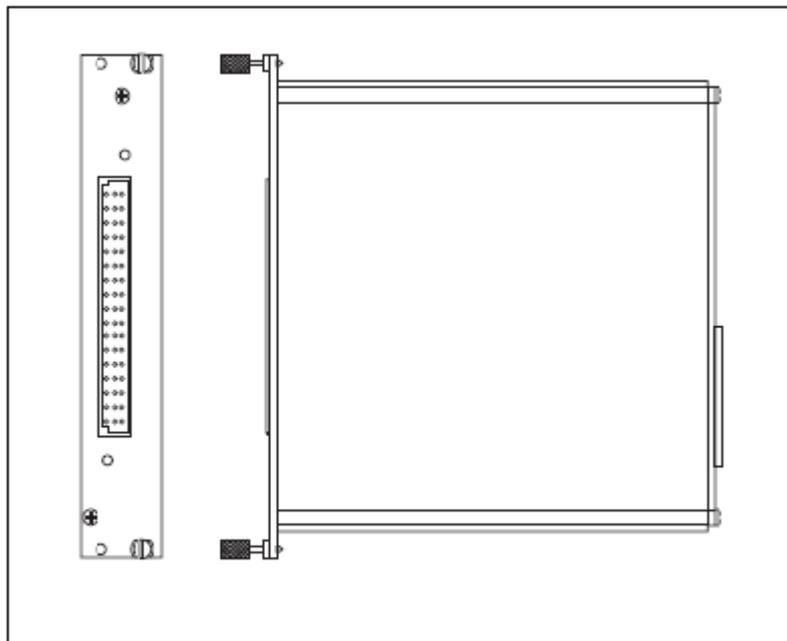
Figura 3.13 Modulo SCXI 1125 vista frontal y lateral.[\[11\]](#)
