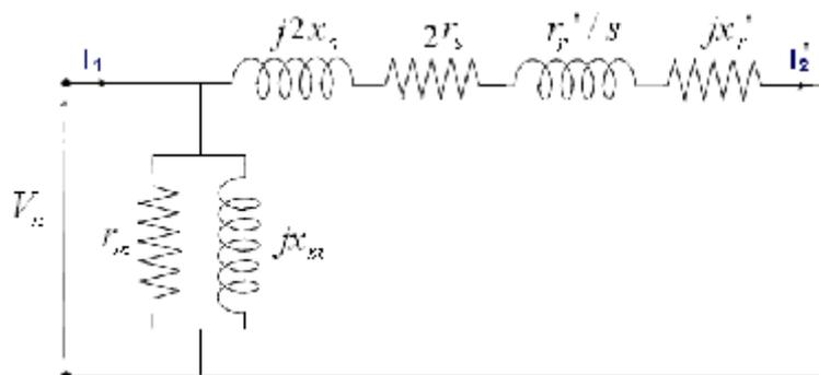
Figura 1.21 Circuito equivalente aproximado del motor en el arranque por devanados parciales.
