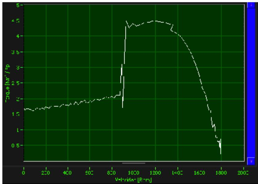
Figura 4.29 Torque en Arranque por Autotransformador 75%Vn (TERCO)
