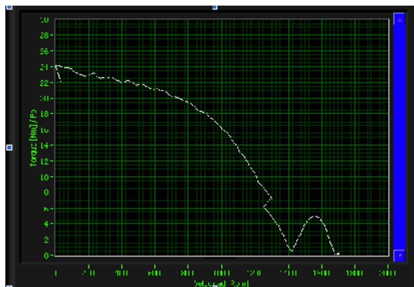
Figura 4.38 Torque en Arranque Directo Estrella Paralelo
