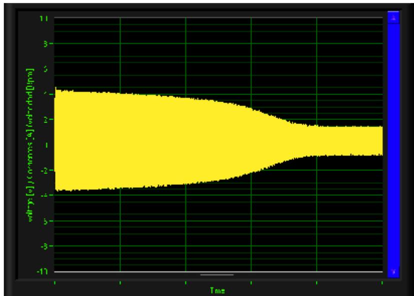
Figura 4.21 Corriente en arranque al 50% del voltaje nominal
