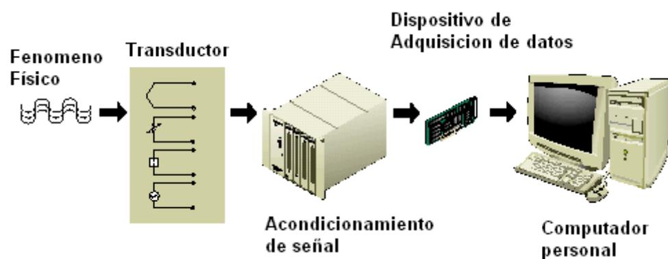
Figura 3.1 Elementos para una adquisición de datos.
