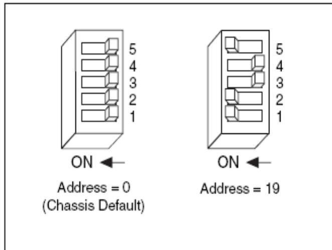
Figura A - 7 Ejemplo de configuración de dirección
