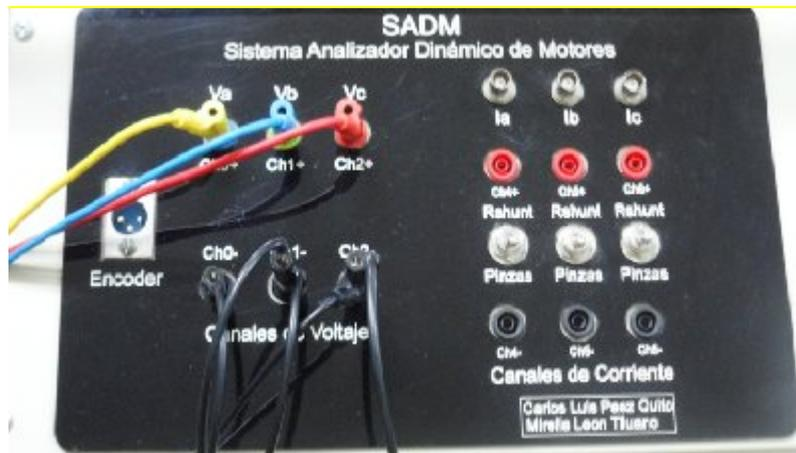
Figura A - 17 conexiones de Voltaje en el SADM
