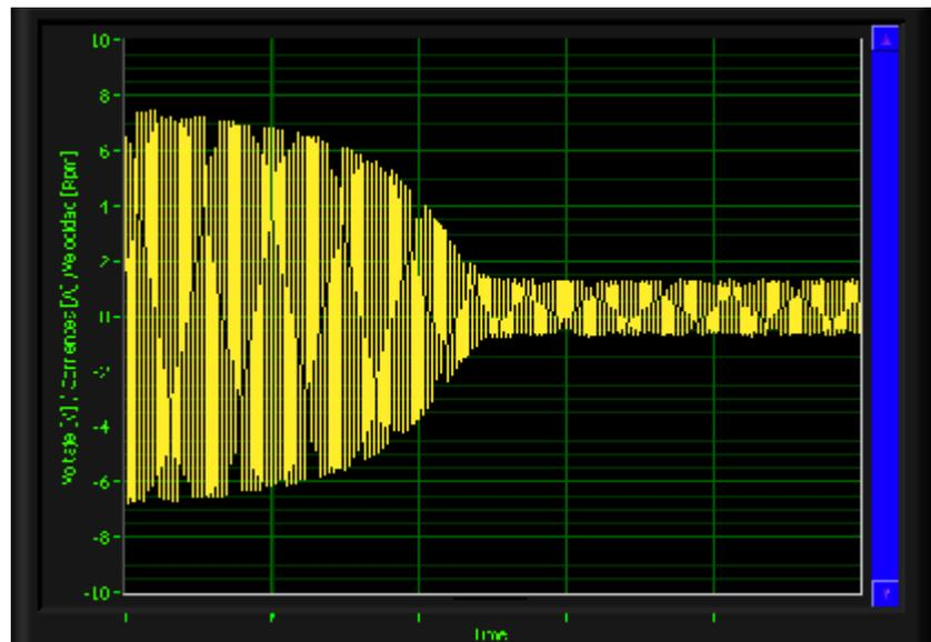
Figura 4.15 Corriente de arranque sin quitar resistencias estáticas
