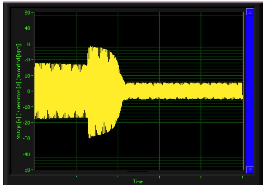
Figura 4.43 Corriente en Arranque por Devanados Parciales
