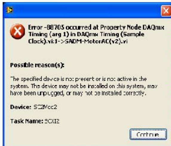
Figura A - 31 Error Mostrado del DAQmx Timing
