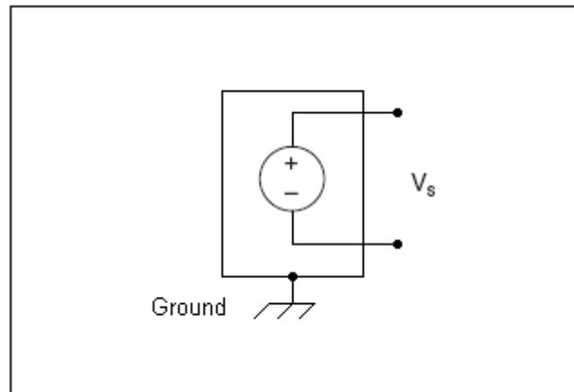
Figura 3.3 Señal de fuente flotante [7]
