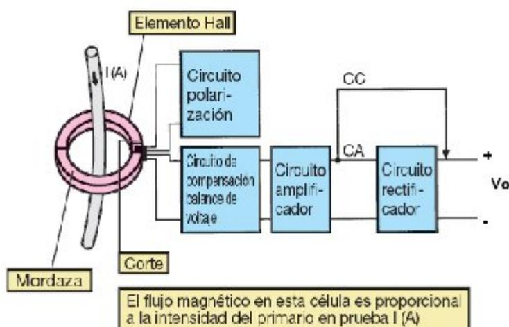
Figura A - 2 Principio de pinza amperimétrica AC/CC
