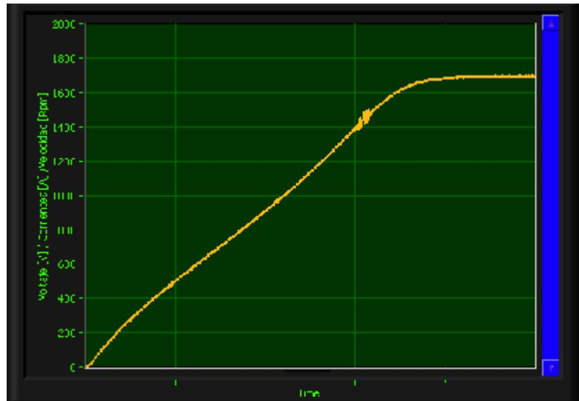
Figura 4.22 Velocidad en arranque al 50% del voltaje nominal
