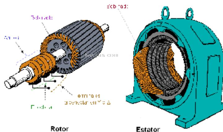
Figura 1.9 Rotor y estator de un motor de inducción de rotor devanado [1]
