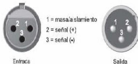
Figura A - 13 Funcionamiento de Conectores XRL (Cannon)
