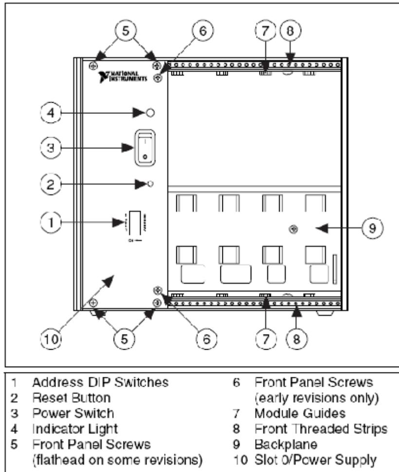
Figura 3.10 Diagrama de Vista Frontal del NI SCXI – 1000. [8]
