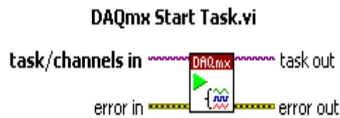
Figura 2.21 Función DAQmx Start Task.
