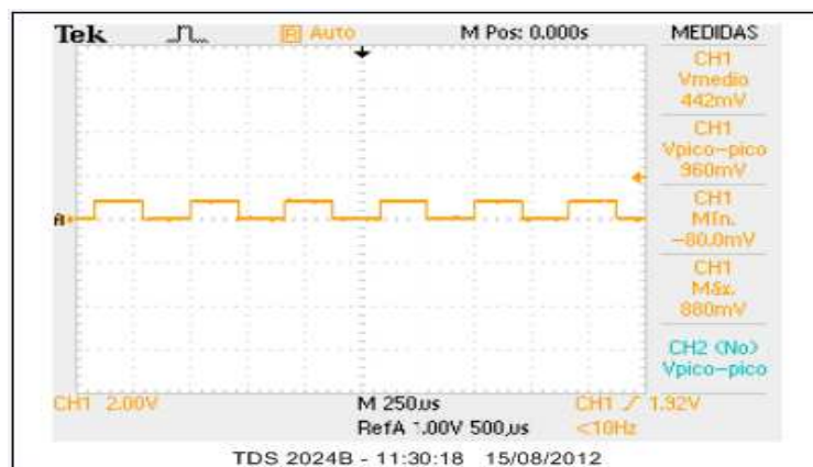
Figura 4.34 Señal en la base del transistor 2N3904
