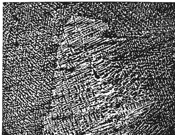
Figura N° 21 Fotomicrografía de la Aleación Bronce al Silicio lote 1 más 5% Cu
