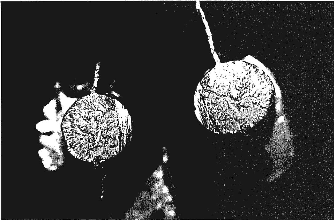
Figura N° 17 Fotografía de la Fractura por Impacto Lote 1 más el 10% de Cobre
