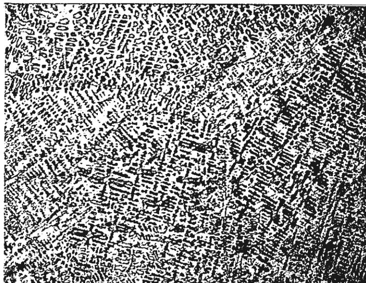
Figura N° 20 Fotomicrografía de la Aleación Bronce al Silicio Lote 1.
