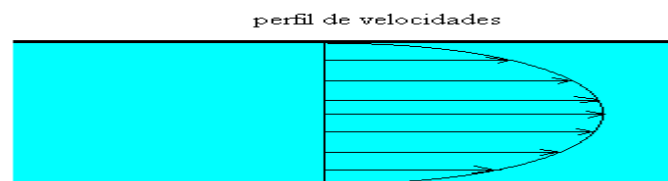
Figura 1.6.- Perfil de velocidades de un fluido en el interior de un cilindro
