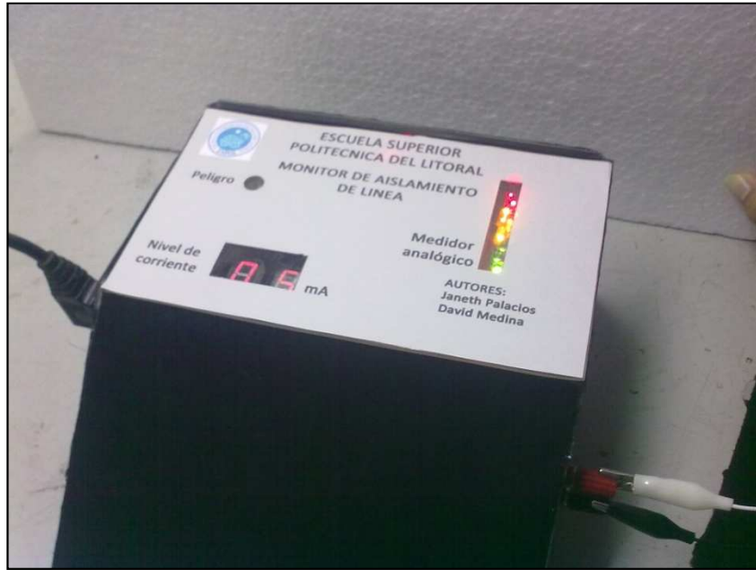
Figura D-3 Vista Superior del Equipo en situación de Peligro.
