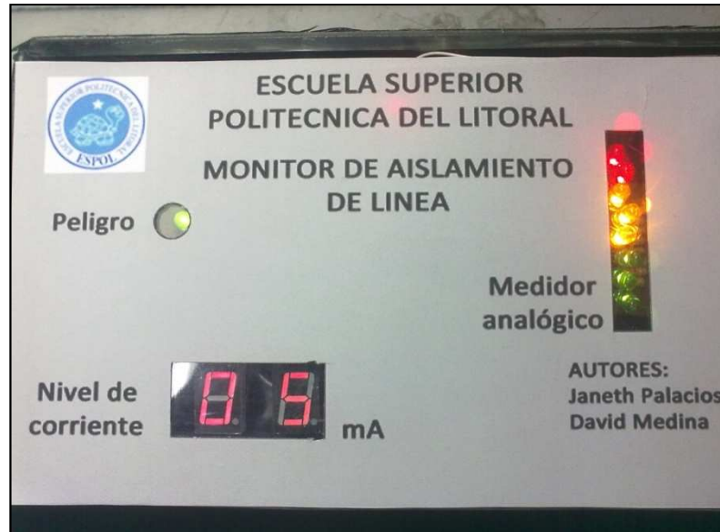
Figura D-1 Vista Frontal del equipo en situación de peligro.
