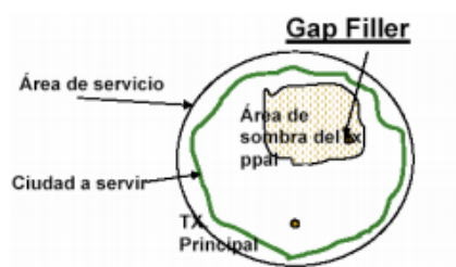
FIGURA 4.13 UTILIZACIÓN DE GAP FILLER
