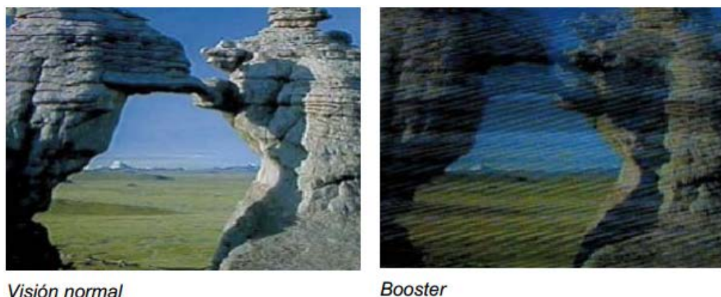
FIGURA 2.16 EJEMPLO DE INTERFERENCIA POR AMPLIFICADOR DAÑADO
