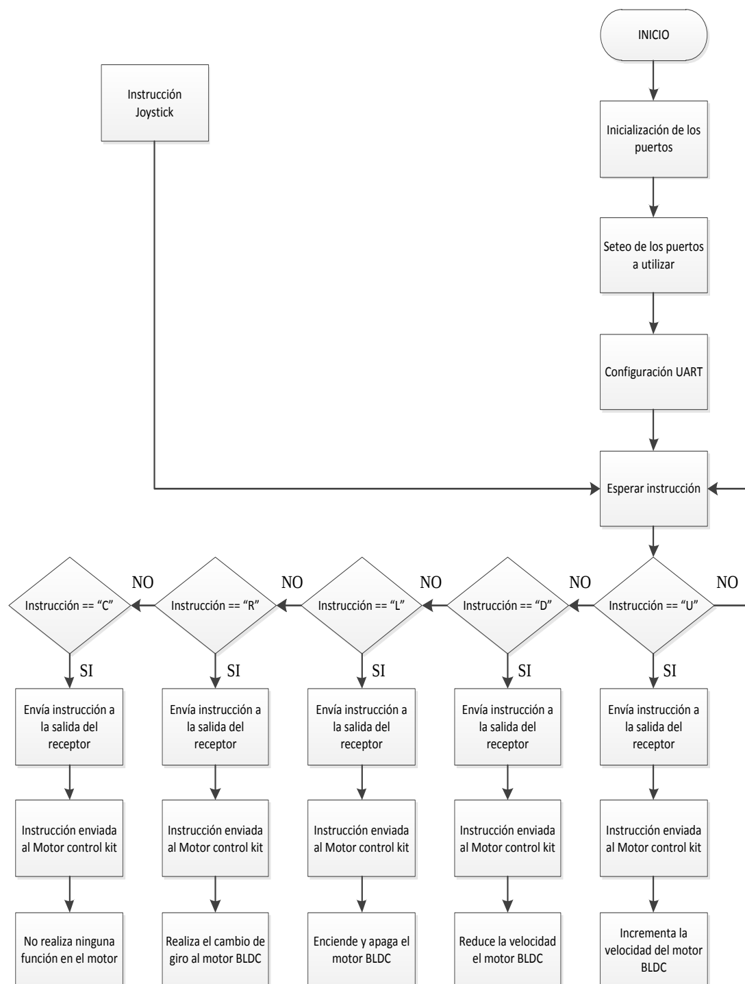
Figura 3.11 Diagrama de Flujo (Receptor) del ejercicio 3.
