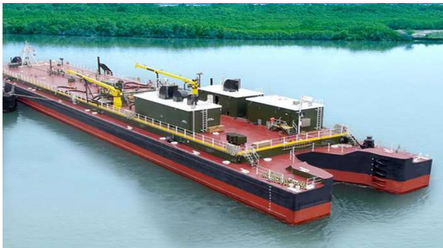
Ilustración 7. "Ayampe" barcaza articulada operativa en Ecuador. (Fuente: Transfuel Group).
