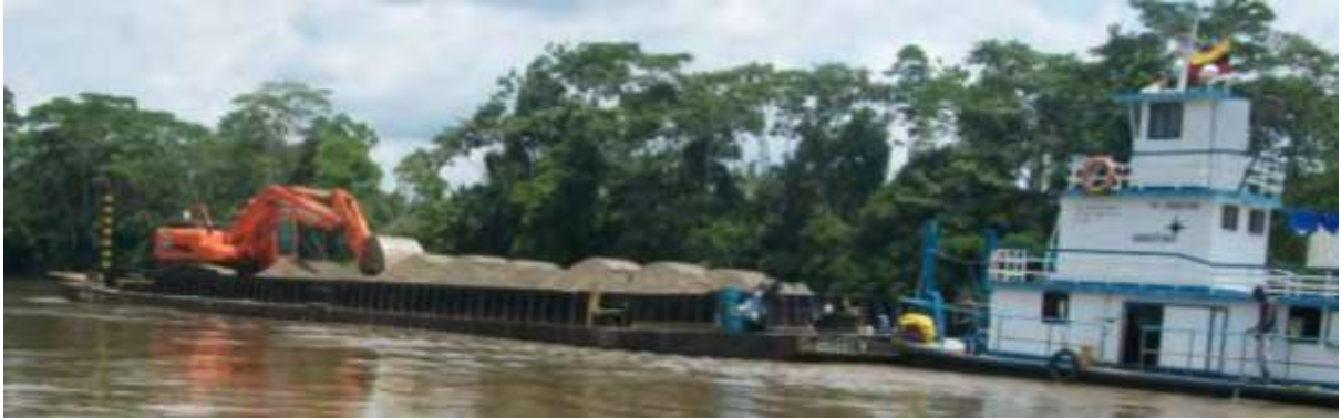
Ilustración 11. Barcaza articulada operando con remolcador en Río Napo (Fuente: Estudio Binacional de Navegabilidad en el Río Napo).
