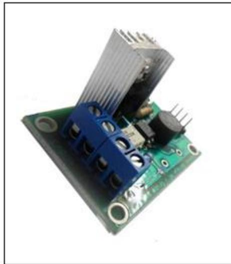
**Figura 3.6 Módulo Control AC Carga Resistiva**
