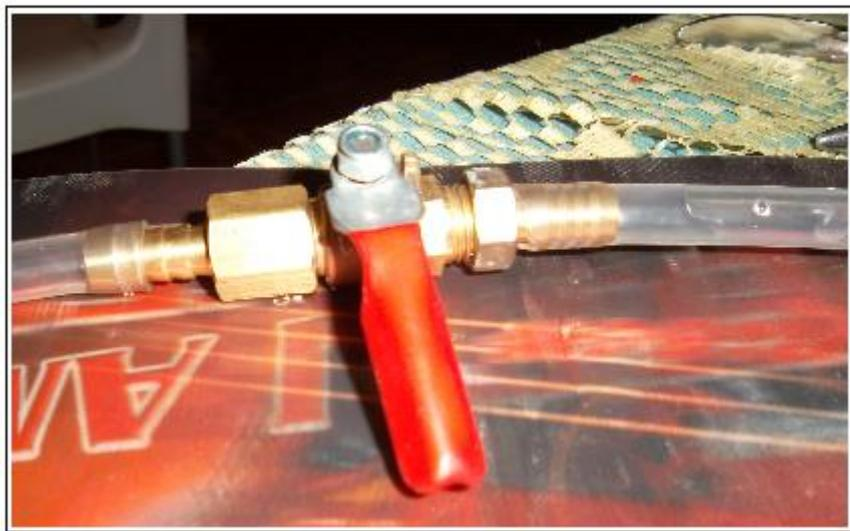
**Figura 3.7 Válvula de Acción manual**
